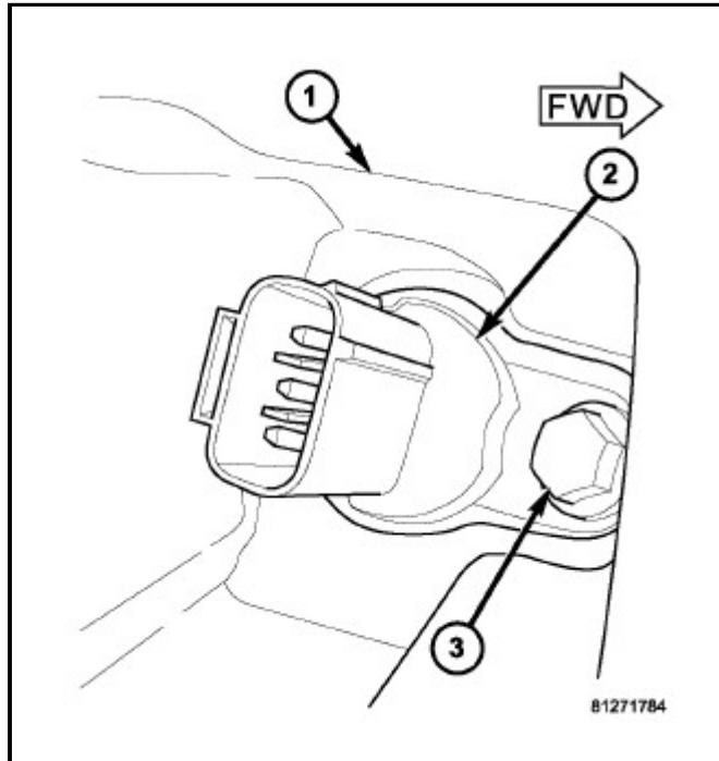
4. 将电气插头(4)连接到CMP传感器(1)上。
