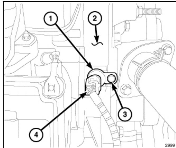
3. 拆下CMP传感器固定螺栓(3)。
