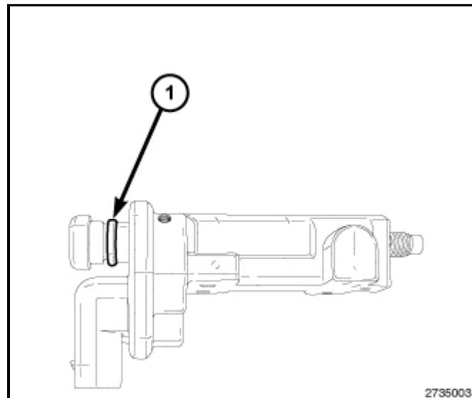
**注意:** 所显示的是右侧**CMP**传感器, 左侧**CMP**传感器与之类似。如果右侧和左侧**CMP**传感器都已拆下, 则将它们安装到它们原来的位置上。
