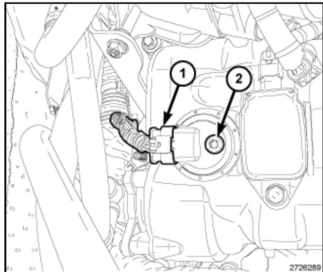
**小心:** 磁性正时轮不得与磁铁(传感工具、磁盘等)或任何其他强磁场接触。这将破坏正时轮将凸轮轴位置正确地传送到凸轮轴位置传感器的能力。
