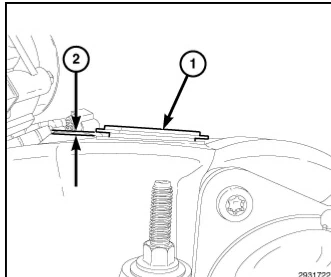
4. 传感器安装螺栓O形圈(1)如未损坏，则可重复使用。
