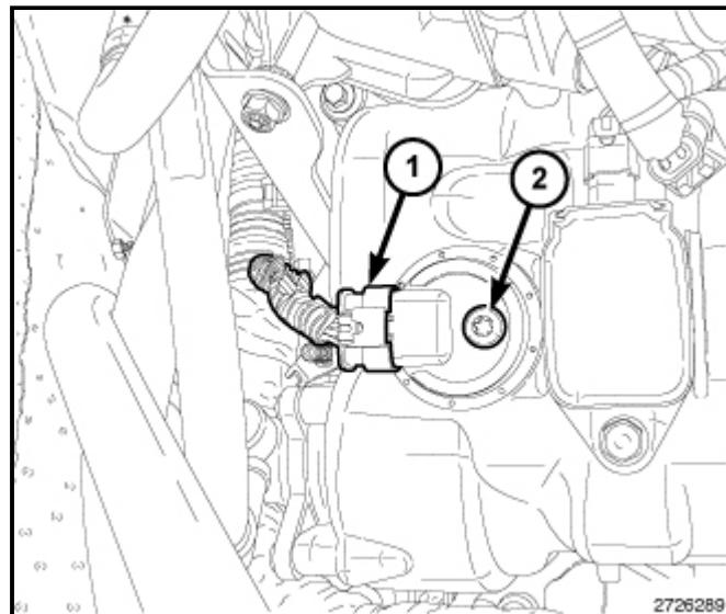
5. 从缸盖罩中拔出传感器和安装螺栓。
