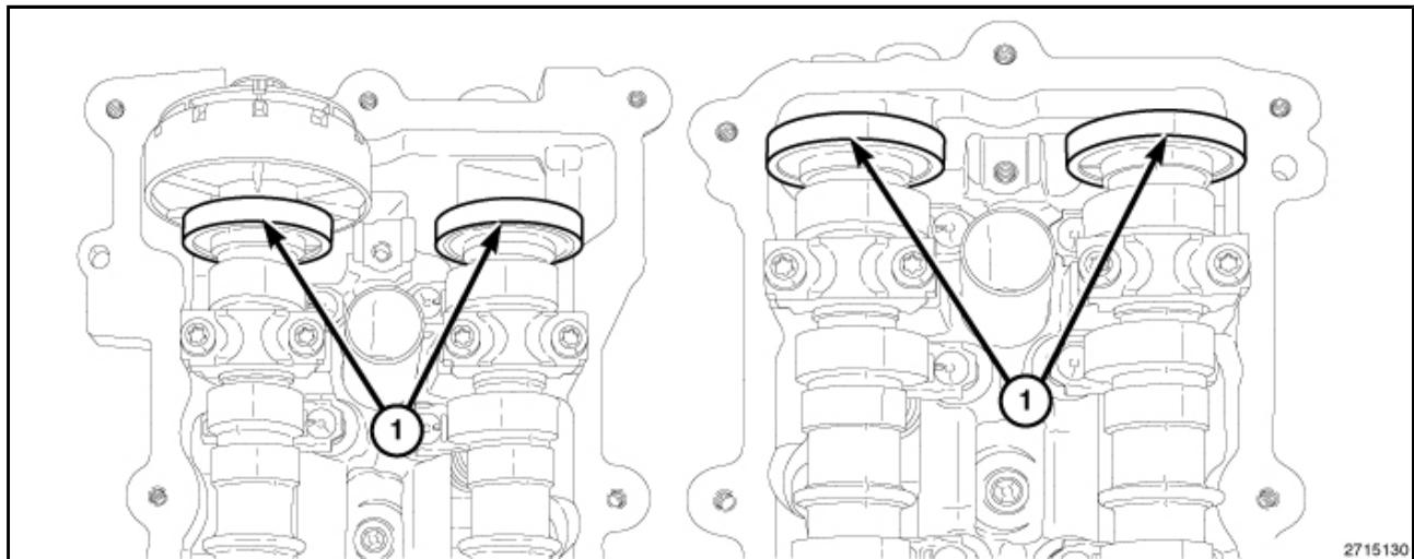
**小心:** 磁性正时轮不得与磁铁(传感工具、磁盘等)或任何其他强磁场接触。这将破坏正时轮将凸轮轴位置正确地传送到凸轮轴位置传感器的能力。
