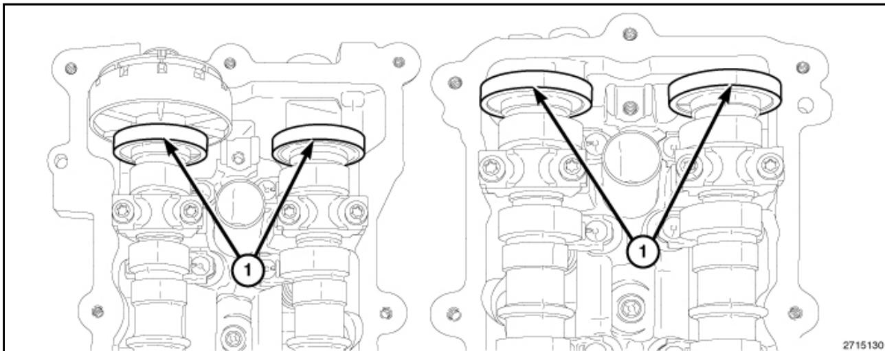
**小心:** 磁性正时轮(1)不得与磁铁(传感工具、磁盘等)或任何其他强磁场接触。这将破坏正时轮将凸轮轴位置正确地传送到凸轮轴位置传感器的能力。
