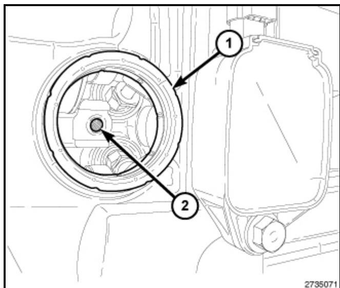
3. 如果需要，则在缸盖罩中安装一个新的CMP传感器密封件(2):
