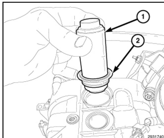
**注意:** 如果CMP传感器密封件(1)安装正确，则在缸盖罩和密封件上凸缘之间有一个1.5 - 2.0 mm (0.06 - 0.08 in.)的间隙。
